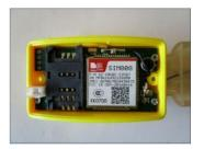
Осторожно отвинтите два винта, с помощью отвертки, входящей в пакет поставки. Всегда используйте только предлагаемую отвертку. Аккуратно откройте пластиковую крышку, обращая внимание на кабели аккумулятора и вставте SIM-карты, как показано на фотографии выше. Затем плотно закройте пластиковую крышку и прикрутите два винта. Обязательно плотно закройте пластиковую крышку, чтобы трекер был водонепроницаемым.
